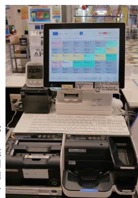
自動つり銭機能がついたPOSレジ。モニターでは、売上げや会員の利用履歴など各種データが瞬時に表示できる
